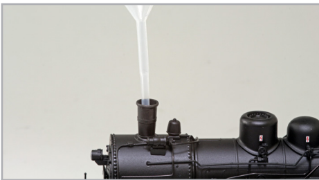
Abbildung 7: Befüllen der T18 mit Rauchöl
